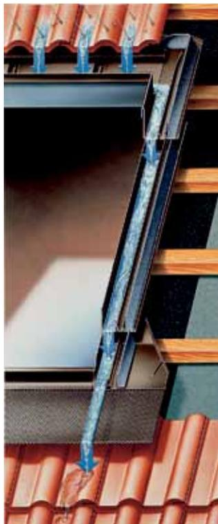
Оклад — это система желобов для водонепроницаемого соединения окна с любым кровельным материалом. Конструкция оклада исключает проникновение влаги к деревянным частям окна и внутрь помещения. Оклады и накладки для окон в стандартном исполнении выполнены из алюминиевого листа и окрашены в темно-серый цвет (RAL 7043). Для медных кровель следует использовать медные оклады и окна с медными накладками.
