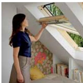
Ручка в верхней части окна позволяет установить окно на оптимальной высоте, а также разместить под окном мебель. Окна с верхним открыванием применяются для установки в широком диапазоне высот. Идеальная высота – 90-120 см от пола (что дает наиболее комфортный вид из окна и контакт с природой). При установке на высоте 120-170 см от пола можно открывать с помощью стержня, 170 см и выше – с помощью шнура для открывания или с пульта (дополнительная опция).
